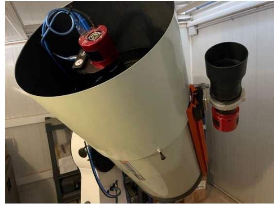
Figura 2: Astrógrafo con cámara CMOS conectada en espejo secundario (Fuente: ECS).
